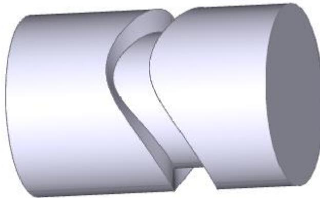
Die Einfräsung wurde in jeder Schnittebene unterschiedlich verschoben.
