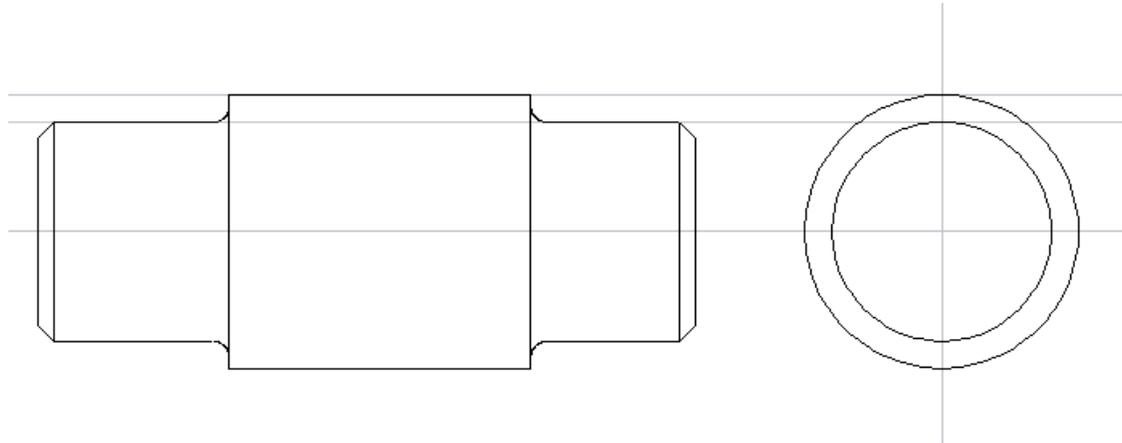
Beispiel: Verwendung von Konstruktionslinien um eine Seitenansicht zu erstellen
