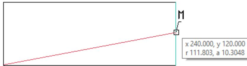
Automatisches Erkennen eines Fangpunktes.
