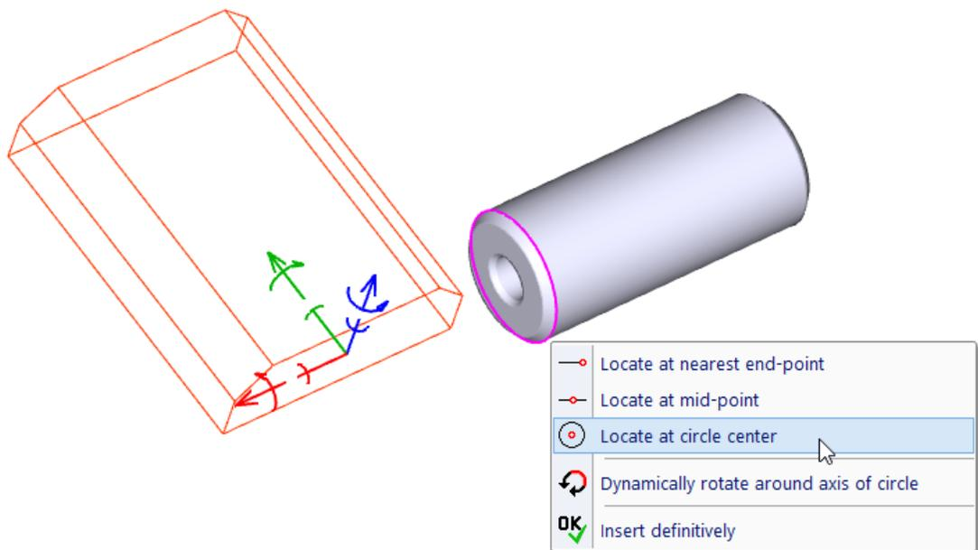
Solid-Positionierung, Rechtsklick auf die Kante eines anderen Solids.
