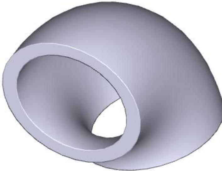
Beispiel der teilweisen Drehung eines geschlossenen Profils
