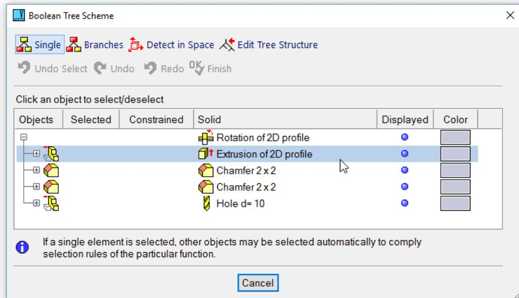
Der Mauszeiger über einem Element des Schemas hebt das entsprechende 3D-Objekt hervor (Highlight).
