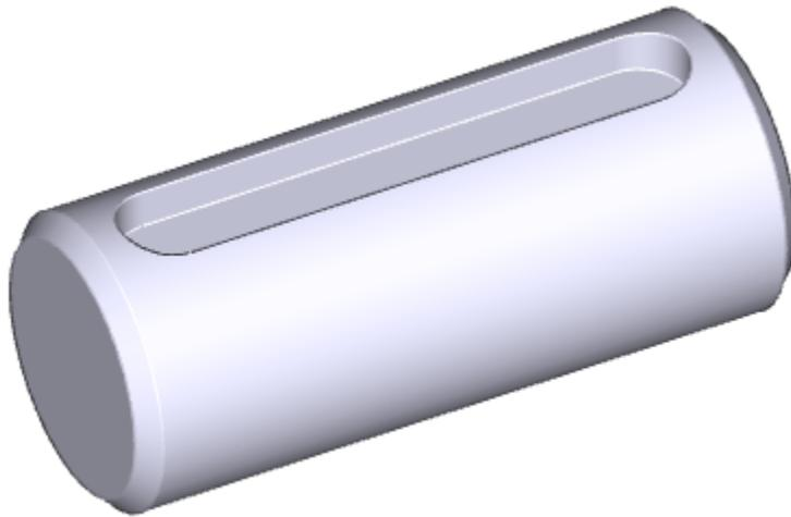
Das resultierende Solid. Die Passfeder wird gelöscht.
