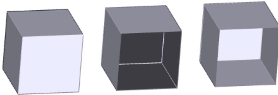
Beispiel einer geschlossenen Fläche, eines fehlendes Flächenstück und einer Offenen Schale
