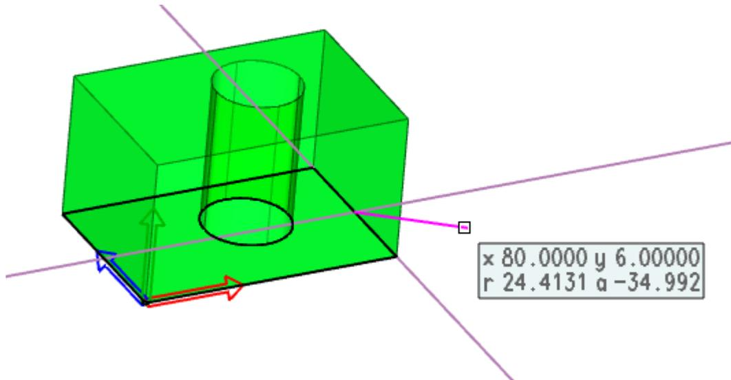
Beispiel temporärer Konstruktionslinien beim Skizzieren. Temporäre Linien werden an der zuletzt gewählten Position beim Zeichnen von Linien eingefügt.
