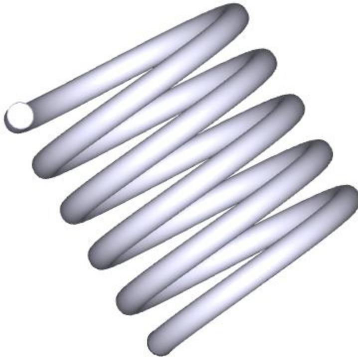
Beispiel einer Feder, definiert durch ein Kreisprofil normal zur Schraubenachse (Normalschnitt).
