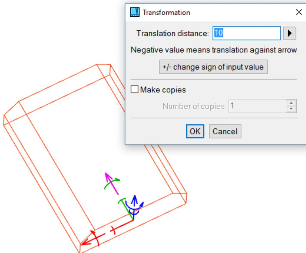
Beispiel für eine Solid-Transformation. Das Solid wird in Richtung seine Z-Achse verschoben.
