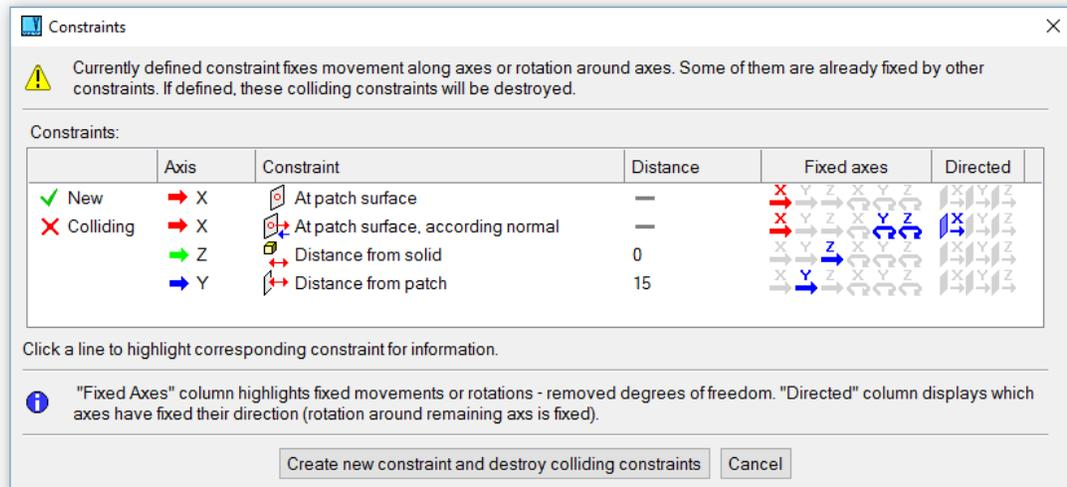
Beispiel einer Kollision einer neuen Bedingung mit einer bereits bestehenden.
