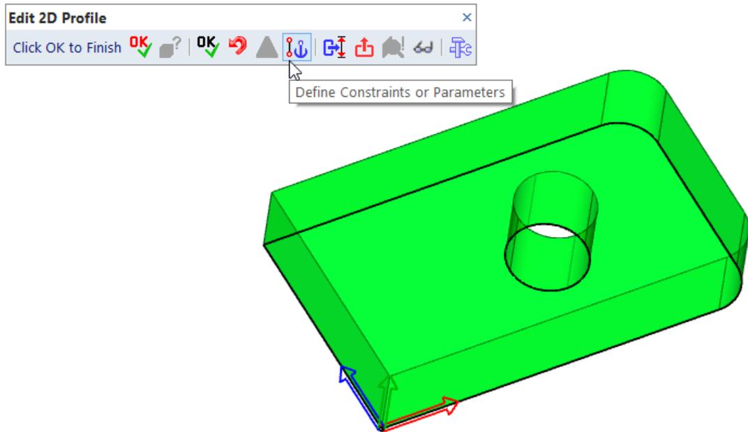
Vom 2D-Profil Bearbeitungs-Modus in den Modus für "Solidprofil Bindungen" umschalten
