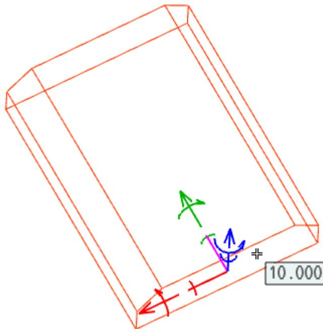
Beispiel für dynamisches Ziehen, der Abstand wird bezogen auf den Start der Zieh-Bewegung angegeben. Das Solid wird entlang der Z-Achse verschoben.
