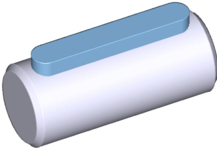
Die Passfeder wird in die Welle abgesenkt.
