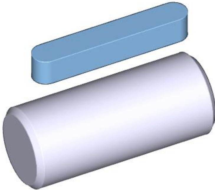
Beispiel für Volumen abziehen, Werkzeug löschen. Die Passfeder ist das Schneidwerkzeug, die Welle das Wurzel-Solid.
