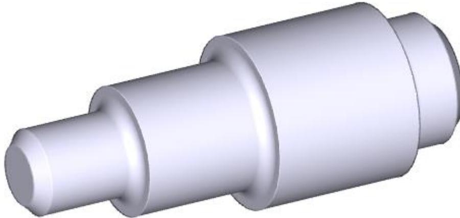
Beispiel einer Vollständigen Drehung eines offenen 2D-Profils.
