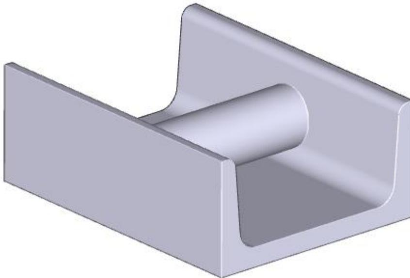
Das resultierende Solid. Nur die mittlere Sektion des Zapfens wurde hinzugefügt.
