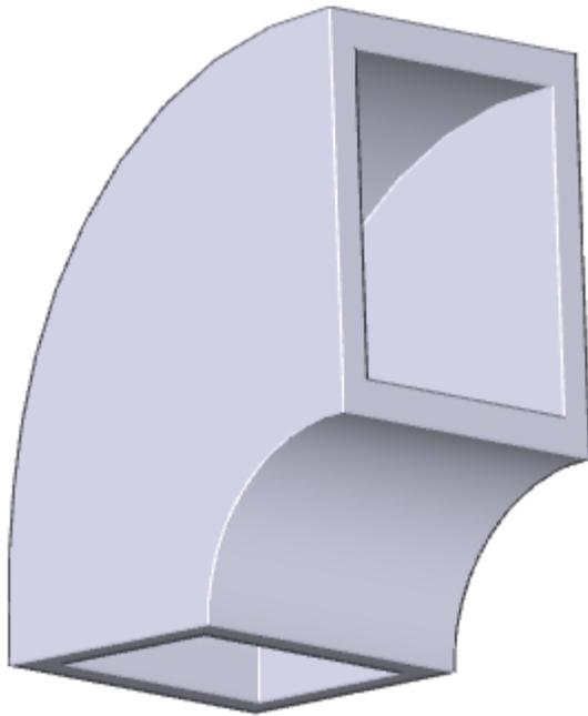
Beispiel für einen gedrehten Übergang, bestehen aus einem Profile-Übergang mit Drehung
