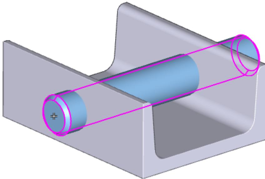
Beispiel für selektives Vereinigen. Der Zapfen soll mit dem U-Eisen vereinigt werden; dazu wird er an der im Bild gezeigten Stelle ausgewählt.
