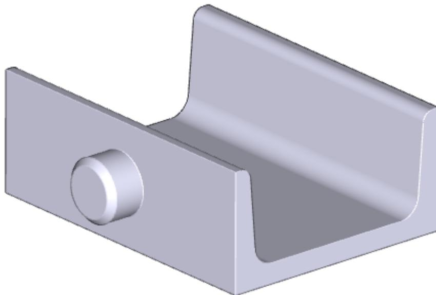
Das resultierende Solid. Nur der ausgewählte Abschnitt wurde hinzugefügt, der Rest des Zapfens wurde gestutzt.
