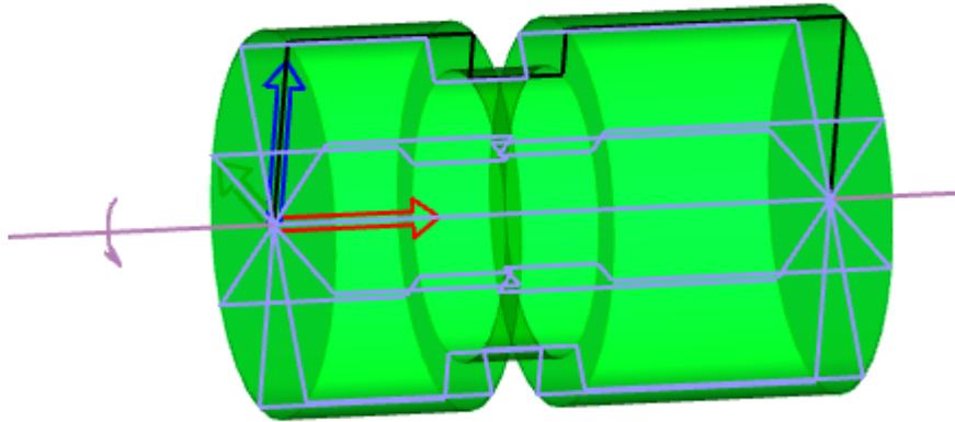
Im ersten wird das Solid vom gedrehten Profil erzeugt.
