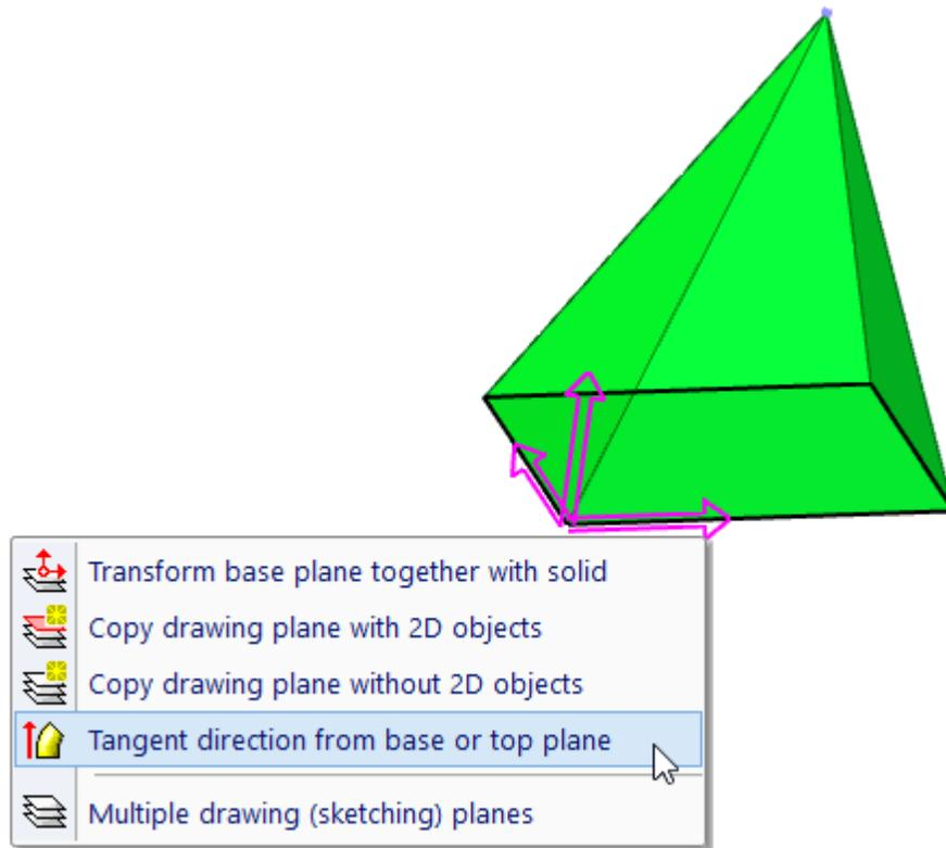
Festlegung der Tangentenrichtung des Übergangsprofils
